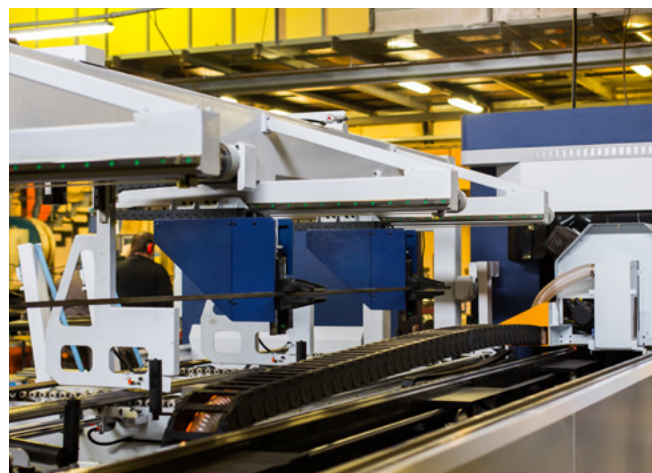
Csövek és zártszelvény profilok hajlítása hagyományos és 3D CNC hajlítógéppel (max. Ø60 x 5 mm)
